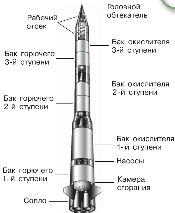
Рис. 18 Схема устройства ракеты-носителя
